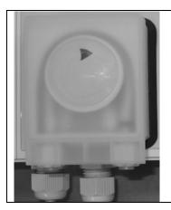
Снимите прозрачную крышку корпуса насоса и черную накладку ротора.
