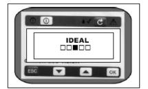
На дисплее контроллера поочередно отображаются сообщения и символы. Светодиодный индикатор LED 1 мигает. Дозирование отключено.
