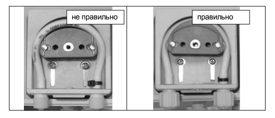
Установите обратно накладку ротора и прозрачную крышку корпуса насоса
